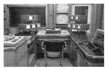
Fig. 3. Bedienungspult des Tonsternpunktes
