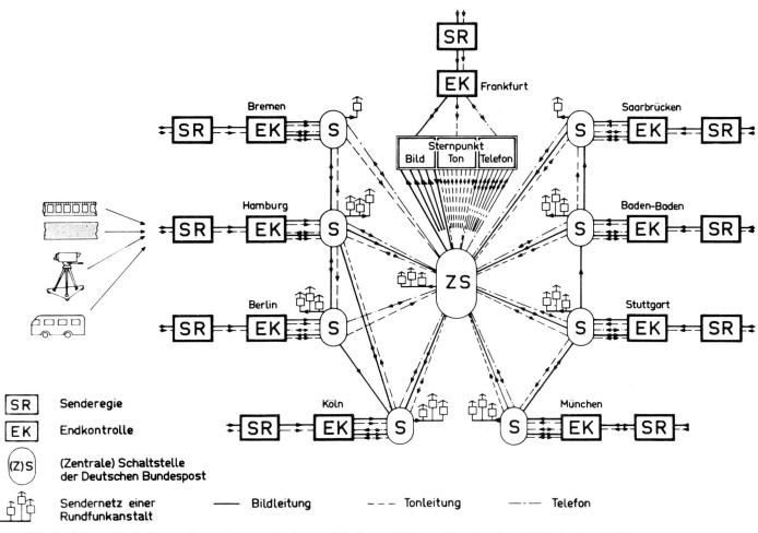
Fig. 1. Schematische Darstellung der verschiedenen Schalt- und Kontrollstellen der ARD für das 1. Fernsehprogramm
