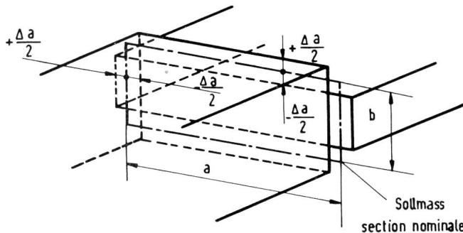
Fig. 1. Zusammenstoßende Hohlleiter mit extremen Dimensionsabweichungen
