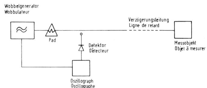
Fig. 7. Prinzip der Reflexionsmessung mit Wobbelgenerator und Verzögerungsleitung
