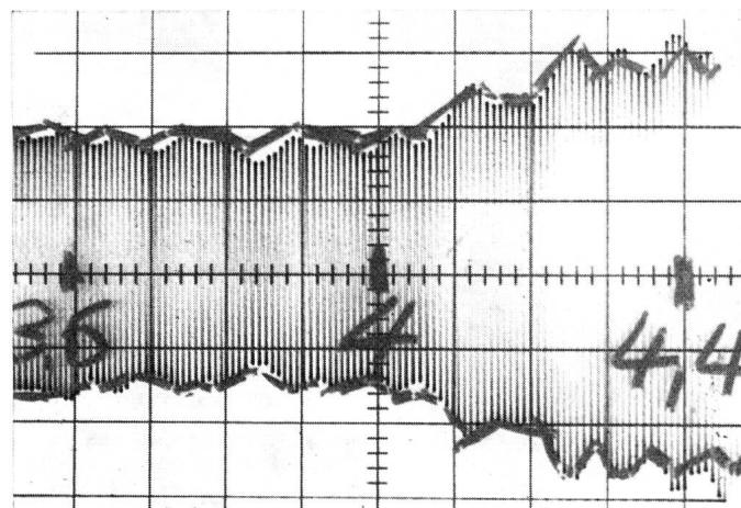
Fig. 11. a) Kurzschlusseichung für  $r=0,1$  zur Festlegung der entsprechenden Eichkurve (dick eingezeichnete Umrandungslinie)
