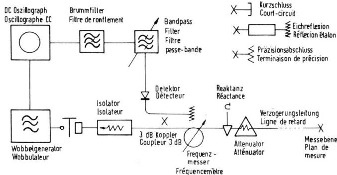
Fig. 8. Praktische Messschaltung für die Reflexionsmessung mit Wobbelgenerator und Verzögerungsleitung
