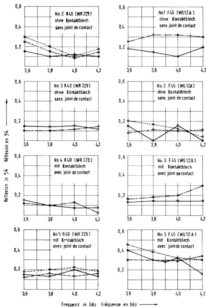
Fig. 6. Reflexionsverläufe von 8 gealterten Flanschverbindungen im 4-GHz-Band
