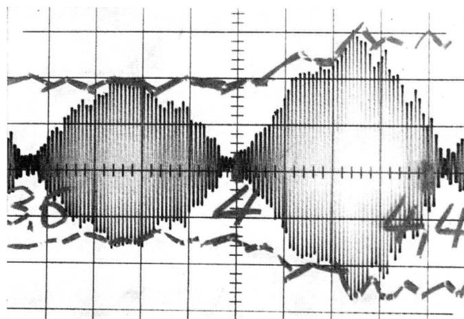
b) Reflexionsverlauf einer Eichreflexion, bestehend aus zwei Einzelreflexionen von  $r=0,05$  im Hohlleiter R 40, im Abstand von 250 mm bei einem Frequenzbereich von 3,6–4,4 GHz. Die dick eingezeichnete Umrandungslinien sind die Eichkurven für  $r=0,1$ .
