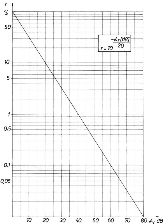
Fig. 9. Reflexion in Funktion der Rückflussdämpfung
