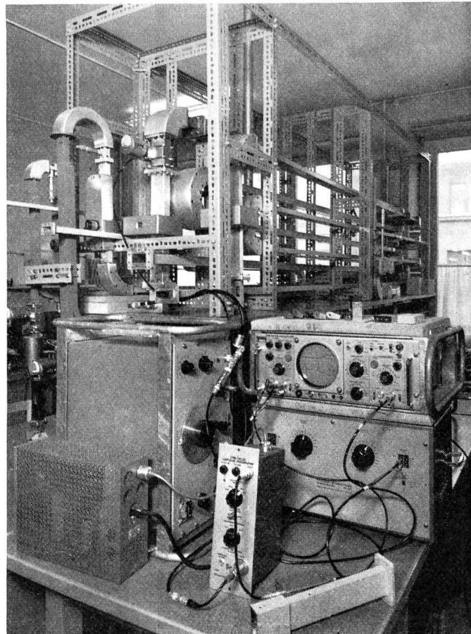
Fig. 10. Ansicht des Messplatzaufbaus nach Figur 8. Links hinten die Hohlleiterschaltung für die Frequenzbänder 3,6-4,9, 5,8-8,2 und 8,2-12,4 GHz
