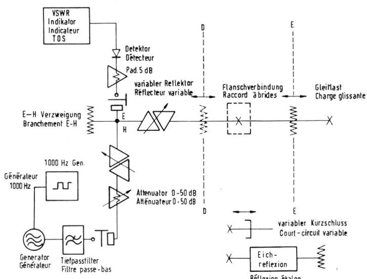
Fig. 12. Kompensationsmessschaltung für Flanschreflexionsmessungen
