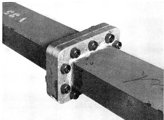
Fig. 5. Künstlich gealterte Test-Flanschverbindung (R 40)
