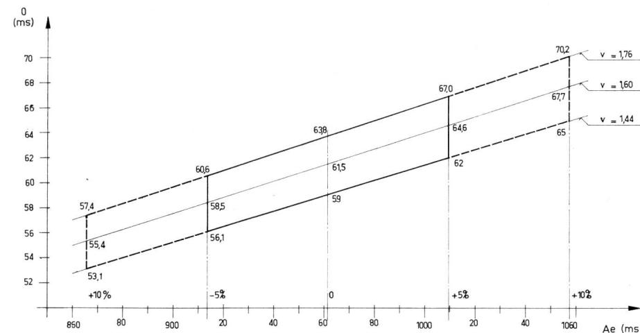
Bei der Wahl der Messmethode wurde auch weitgehend von den langjährigen Erfahrungen in der Abnahme von Nummerschaltern Gebrauch gemacht, und man legte besondere Wert darauf, die totale Ablaufzeit  $Ae$  sowie die Dauer jeder der zehn Öffnungen möglichst genau und übersichtlich zu erfassen.
