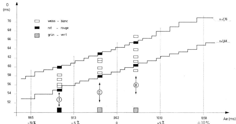
Fig. 6. Die Treppenlinien entsprechen im digitalen System den zulässigen Grenzen für die Öffnungszeiten O in Funktion der Totalablaufzeit Ae (siehe auch Fig. 2)
