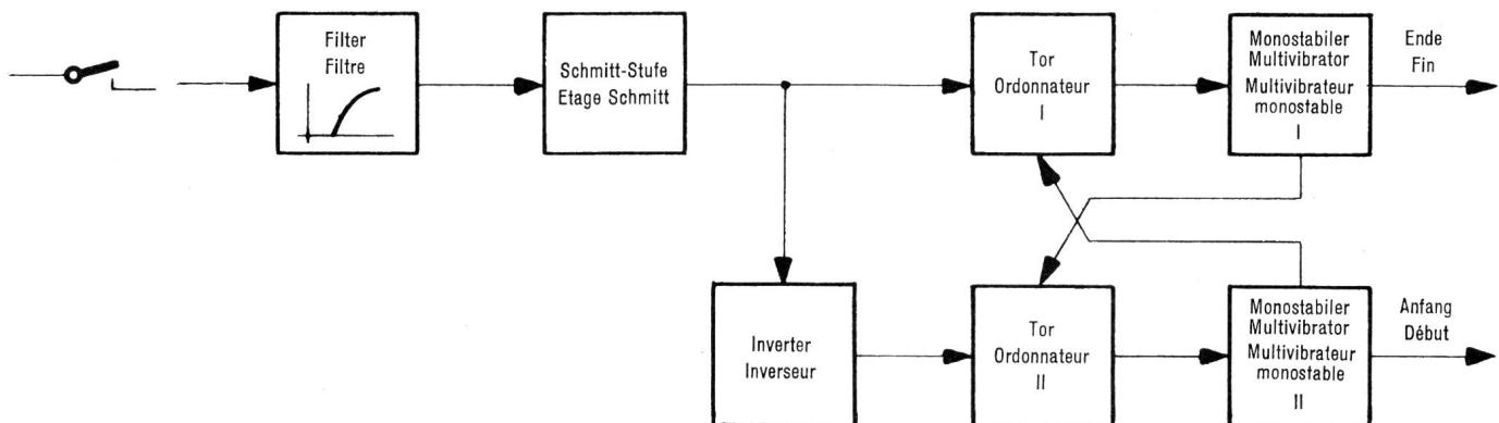
Fig. 9. Blockschema der Eingangsschaltung mit Unterdrückung der Prellung
