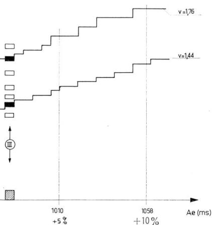
Les escaliers correspondent, dans le système digital, aux limites admissibles pour les temps d'ouverture O en fonction du temps de retour total Ae (voir aussi fig. 2)
