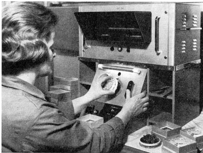
Fig. 7. Der vollständige Messplatz. Die Aufnahme zeigt das Einsetzen eines Prüflings
