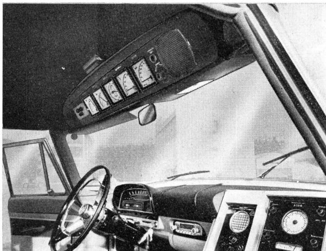
Fig. 5. Instrumenten-Paneel über der Windschutzscheibe
