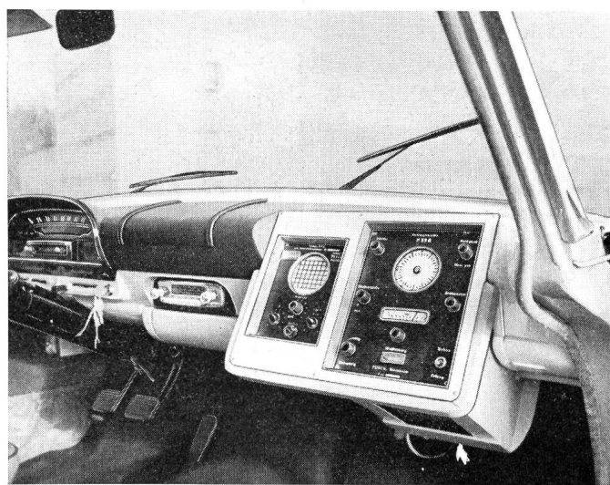
Fig. 6. Frequenz- und Rundsicht-Panoramageräte sowie Autoradio im Armaturenbrett eingebaut
