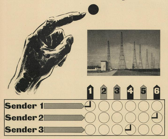
Beliebige Anzahl Sender Beliebige Anzahl Antennen Beliebige Schaltkombinationen Grosse Übersprechdämpfung Gleichmässiger Wellenwiderstand Bedienung von Hand oder durch Fernsteuerung Baukastensystem erlaubt Zusammenbau zu erweiterbaren Gruppen Leistung: 100...500 kW + 100% Modulation
