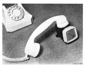
Fig. 2. Amplificateur à liaison électromagnétique non admis par les PTT
