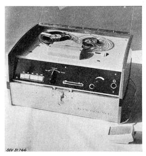
Fig. 3. Appareil moderne de réponse automatique et d'enregistrement de messages
