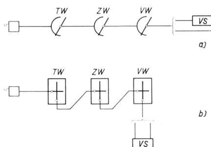
Fig. 5. Etages de sélection d'un système crossbar
