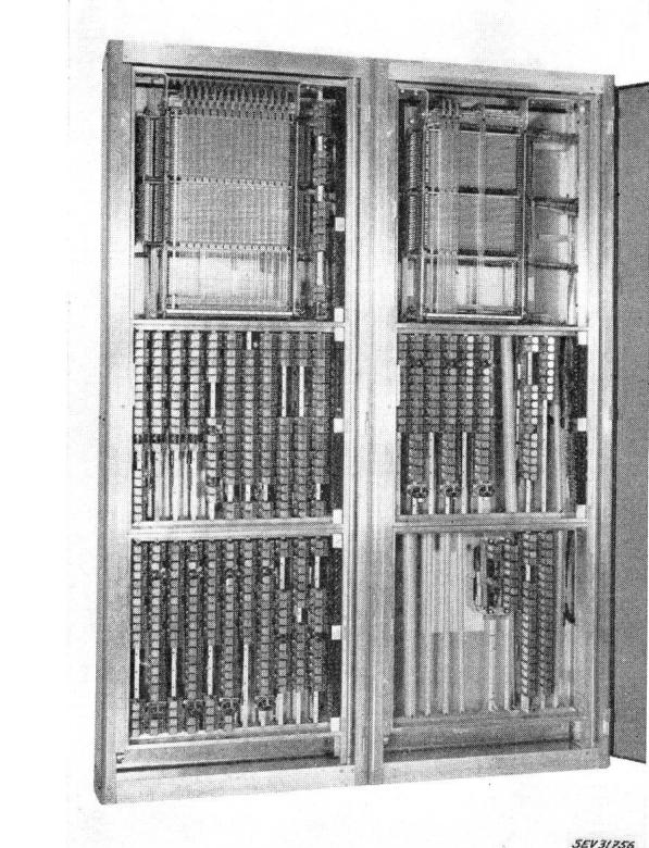
Fig. 10. Petit central d'abonné X/57 pour 57 raccordements d'abonnés et 10 lignes réseau au maximum, équipé de 40 lignes d'abonnés, 7 lignes réseau et 4 circuits de connexion interne
