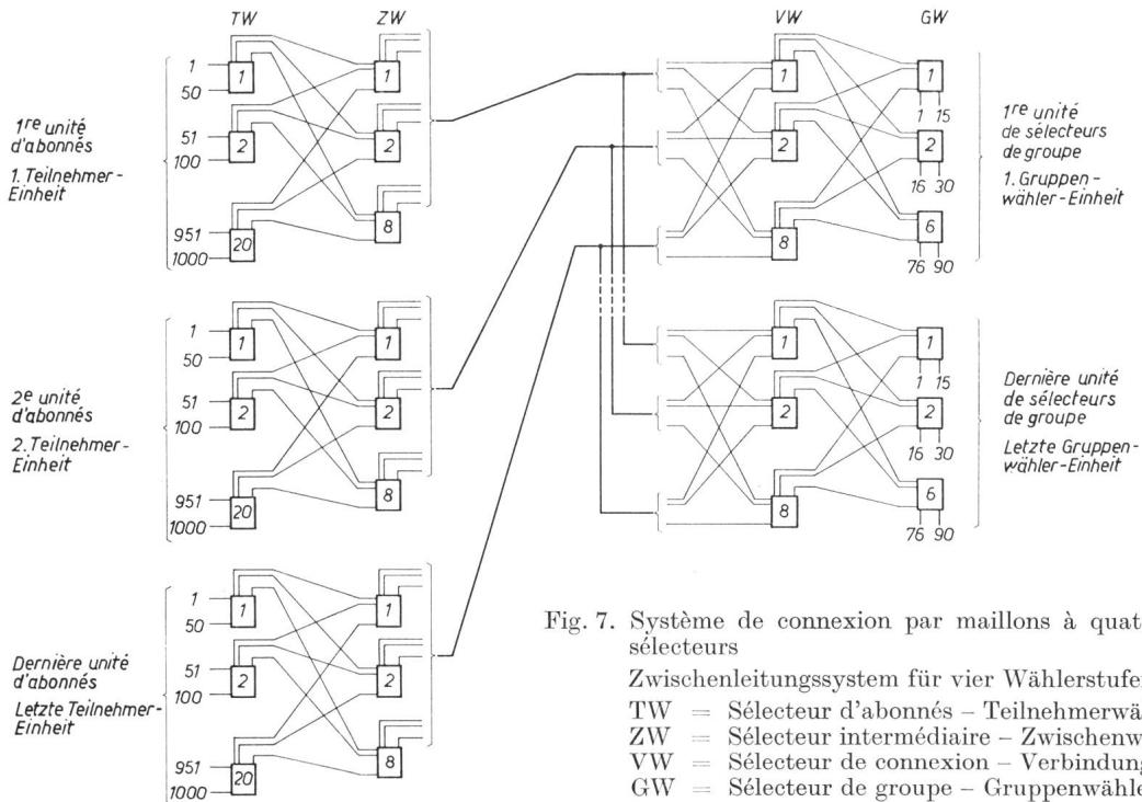
Fig. 7. Système de connexion par maillons à quatre étages de sélecteurs
