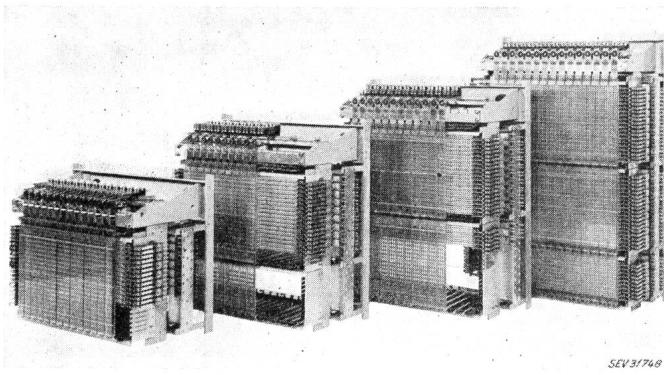
Fig. 2. Sélecteurs crossbars suisses pour 15 barres de jonction et pour 20, 30, 40 et 50 barres transversales
