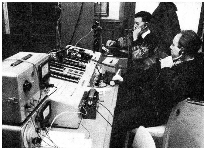
Fig. 3. Fernsehzentrum Wengen. Hauptschaltpult und Zentrale für die Ton- und Verständigungsleitungen der Eurovision während eines Tests
