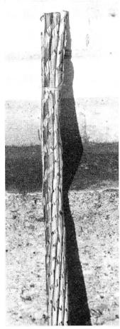
Fig. 2. Die im zerrissenen Kabelstück vorhandenen Adern
