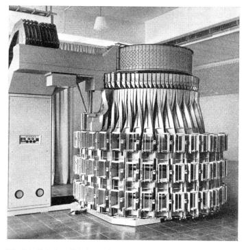
Fig. 15. Behälter-Briefverteilmaschine System Siemens & Halske mit rotierenden Ablagefächern
