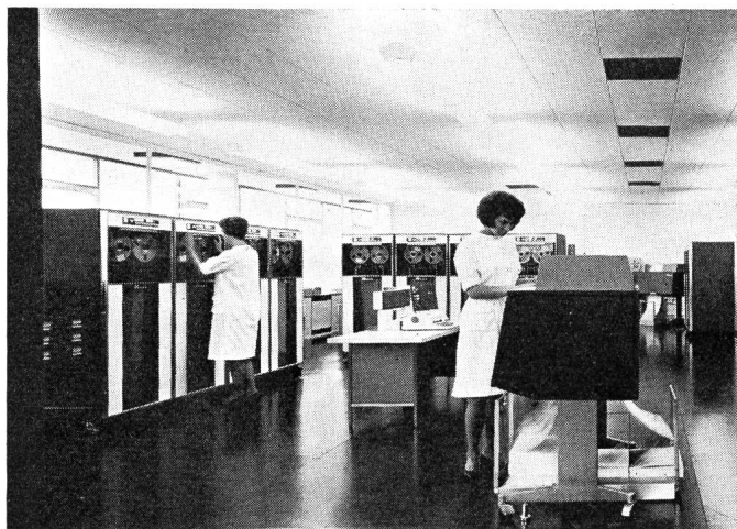
Fig. 5. Die IBM-Anlage 1410 setzt sich u. a. aus acht Bandeinheiten, einem Hochleistungsdrucker (rechts) sowie einem Magnetplattenspeicher (der in Bild 4 im Hintergrund sichtbar ist) zusammen
