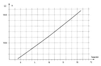
Fig. 3. Schlaufenwiderstand von 8910 m Fülladerpaar 0,6 mm, gemäss den Messungen an der Koaxialkabelanlage Nr. 5 Zürich-Basel, PTT-Kurvenblatt V – 25.274 vom 6. 8. 59
