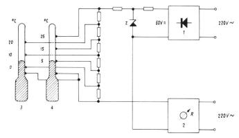
Fig. 1. Kontaktthermometer
