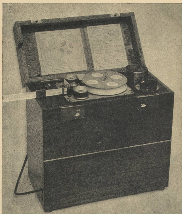
Apparat zur Kontrolle der Gesprächstaxierung
