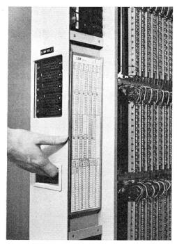
Fig. 5. Wie Bücher aus einem Regal lassen sich die Einschubrahmen der neuen ESM-Vermittlung aus dem kompakten Gestellrahmen herausziehen
