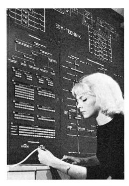
Fig. 3. Prüfroboter melden automatisch allfällig auftretende Störungen und registrieren sie auf einem Lochstreifen. Unser Bild zeigt die Übersichts- und Meldetafel, auf der sich die Informationen aus dem Lochstreifen zur Fehlerlokalisierung übersichtlich darstellen lassen
