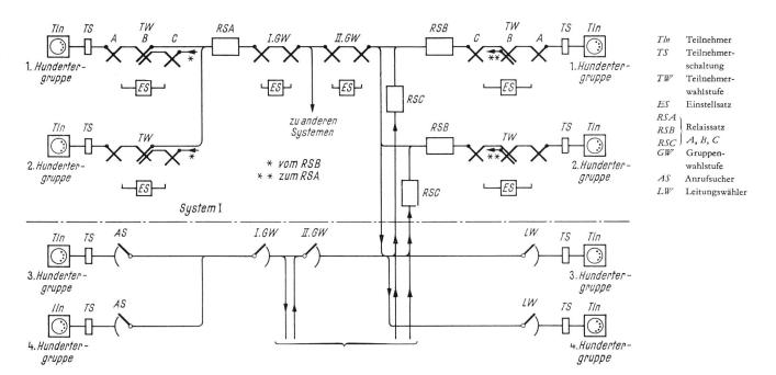
Fig. 2. Prinzipschema einer Versuchs-Telephonzentrale mit Schutzgaskontakten (System I). Aus: Siemens-Zeitschrift Schéma de principe d'un central téléphonique d'essai avec contacts fonctionnant dans une atmosphère gazeuse (système I). Tiré de: Siemens-Zeitschrift
