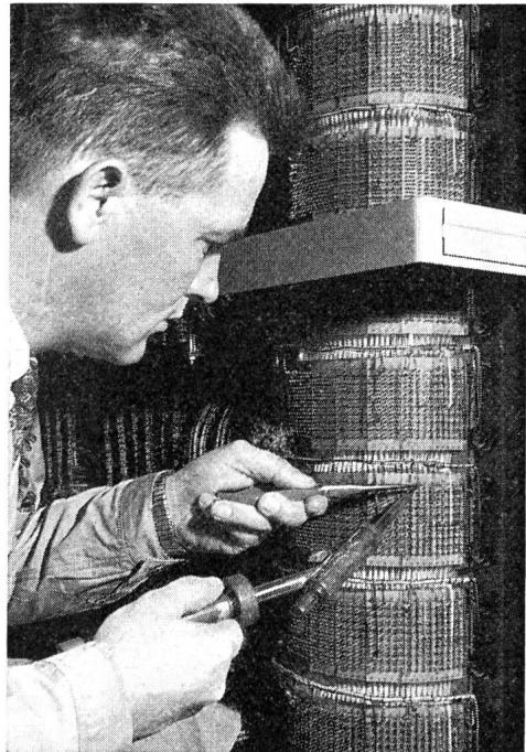
Fig. 1. Verdrahtungsänderungen am Motorwähler des Zeitzonen-zählers einer Albiswerk-Zentrale
