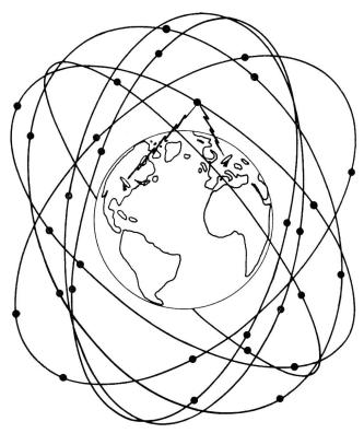
Fig. 4. Système global de satellites asynchrones à orbites différentes, mais situées approximativement à  $5\div10~000~\rm km$  au-dessus de la surface terrestre
