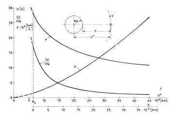
Fig. 1. – La vitesse absolue v (en 1000 km/h) – La durée absolue de révolution u (en h) – La vitesse angulaire  $\alpha$ , par rapport à la
