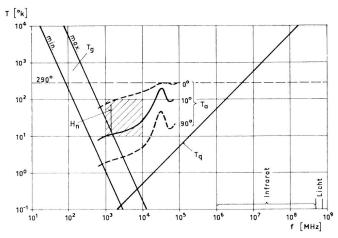
Fig. 5. Température de bruit absolue du ciel en fonction de la fréquence
