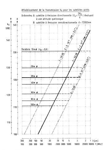
Fig. 8. Affaiblissement de transmission  $\mathbf{b}_{\ddot{\mathbf{u}}}$  pour les satellites actifs
