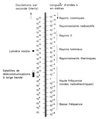
Fig. 6. Spectre des ondes électromagnétiques
