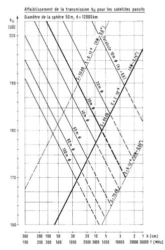
Fig. 7. Affaiblissement de transmission  $b_{\tilde{u}}$  pour les satellites passifs du type «Echo»
