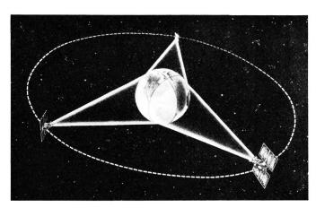
Fig. 2. Système de satellites synchrones dans le plan équatorial (orbite circulaire située environ à 35 800 km de la surface terrestre)
