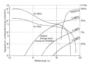
Fig. 1. Spektrale Empfindlichkeit des Infrarot-Resistrons
