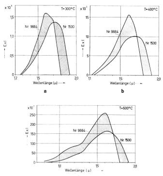
Fig. 5. Zum Vergleich des Wirkungsgrades von Infrarot-Resistrons mit etwas verschiedenen spektralen Verteilungen
