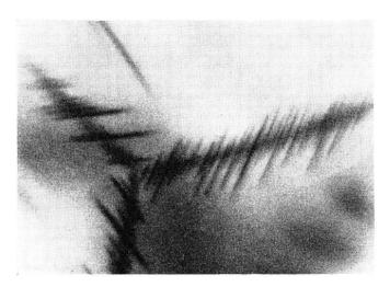
Fig. 3. Durchstrahlungsaufnahme eines Siliziumplättchens, das stark mit Kupfer dotiert ist
