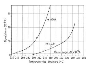
Fig. 2. Signal als Funktion der Temperatur des schwarzen Strahlers
