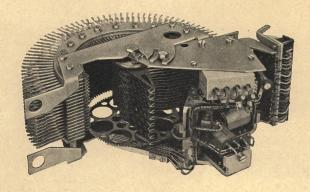
Im Telex-Knotenamt Biel arbeitet der ALBIS-Motorwähler in Verbindung mit teilelektronischen Wahlspeichern
