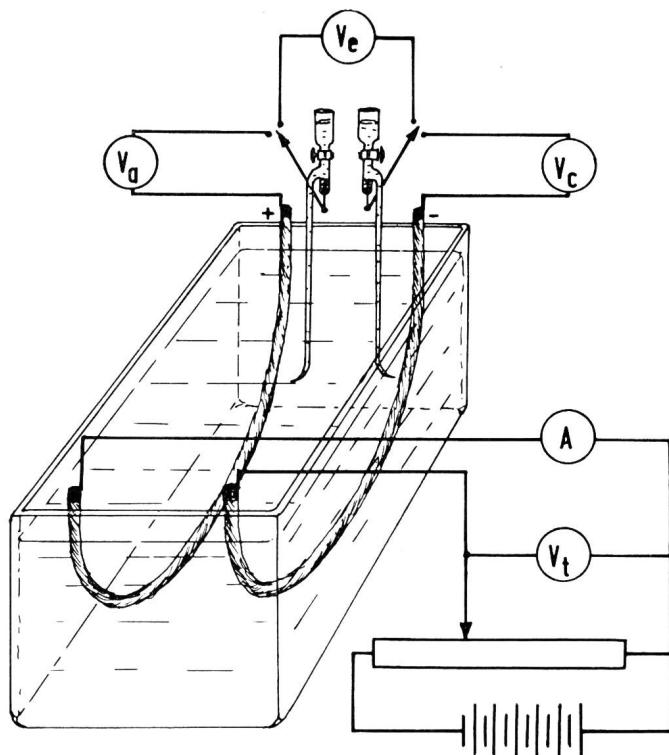
Fig. 1. Versuchsanordnung, wie sie bei den Untersuchungen zur Abklärung des Einflusses von Potentialverschiebungen bei der interkristallinen Bleikorrasion benutzt wurde.
