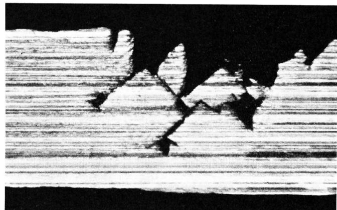
Fig. 3. Querschnitt durch die Korrosionsstelle der Figur 2 mit tiefgreifender, interkristalliner Korrosion.
