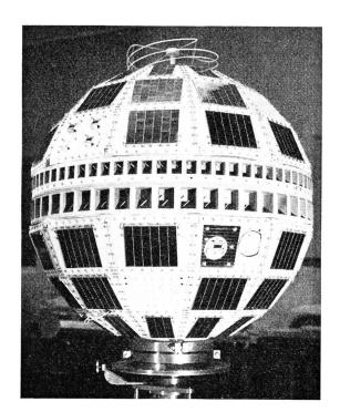
Fig. 16. Aktiver Satellit «Telstar» (ATT) im Versuchsstadium Oben: VHF-Antenne für Grobpeilung sowie Übertragung von Mess- und Steuersignalen
