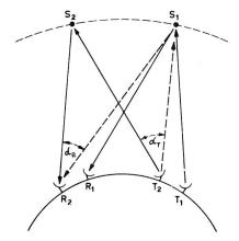
Fig. 13. Gleichkanalbetrieb: für harte Übertragungssysteme  $\sim \alpha \geq 2^{\circ}$ , für weiche Übertragungssysteme  $\sim \alpha \geq 10^{\circ}$
