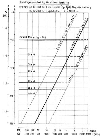
Fig. 8. Übertragungsverlust bü für aktive Satelliten
