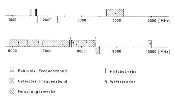
Fig. 14. Frequenzbänder für Satellitenverbindungen (nach einer amerikanischen Studie, vgl. Lit. 1.)
