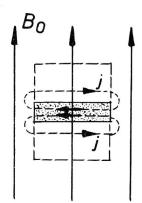
Fig. 4. Prinzipielle Erläuterung zur Entstehung der Alfvénwelle
