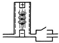
Fig. 1. Erzeugung des linearen Pinch durch eine Kondensatorentladung
