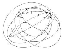
Fig. 4. La forme de la terre est la cause de nombreux mouvements de l'orbite découlée par le satellite. La figure montre les positions de diverses orbites parcourues par le premier satellite artificiel. Les orbites sont représentées de 10 en 10 jours. Le point noir représente la position du périgée (Extrait de la «Revue Technique Européenne»)
