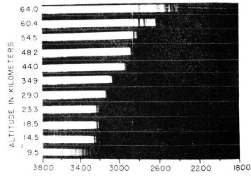
Fig. 6. Spectre du soleil obtenu à diverses altitudes. Le spectre devient de plus en plus riche du côté de l'ultraviolet lorsque l'altitude augmente
