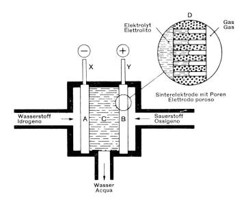
pila, la tensione continua è disponibile in permanenza. La pila a combustibile non possiede parti in movimento, essa è silenziosa e genera praticamente nessun calore nè gas nocivi. Essa costituisce il generatore ideale, ad alto grado d'efficienza. Le grandi centrali a vapore lavorano a temperature d'esercizio che si aggirano sui 600°C e hanno un rendimento pratico del 38% al massimo. Il rendimento pratico delle pile a combustibile può però salire fino all'80%.
