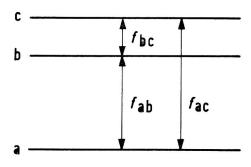
Fig. 3. Energieniveaudiagramm mit den 3 verschiedenen Energiezuständen a, b, c. Unter Einwirkung einer äusseren Pumpfrequenz fac wird das Atom aus dem unerregten Zustand a in den erregten c angehoben; beim Zurückfallen nach b wird Rotlicht emittiert usw.
