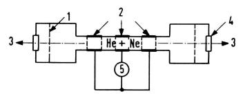
Fig. 4. Prinzip des Bell-Gas-Lasers
