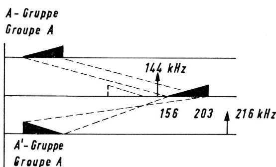
Fig. 11. Modulationsplan für die Umsetzung A → A'
