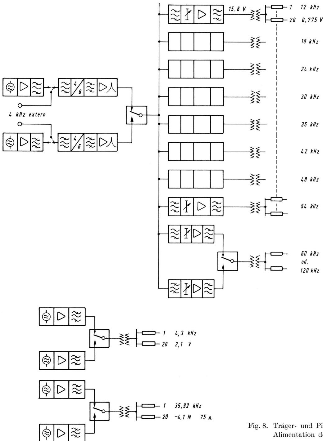
Fig. 8. Träger- und Pilotversorgung
