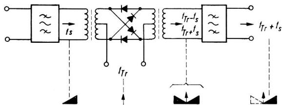
Fig. 7. Prinzip der Ringmodulatorschaltung
