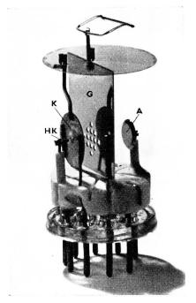
Fig. 2. Innenaufbau des Glimm-Thyratrons
