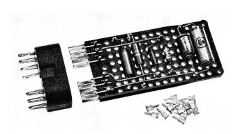
Fig. 6. Standard-Einheits-Steckplatten für den Aufbau von elektronischen Bausteinen und Schaltungen
