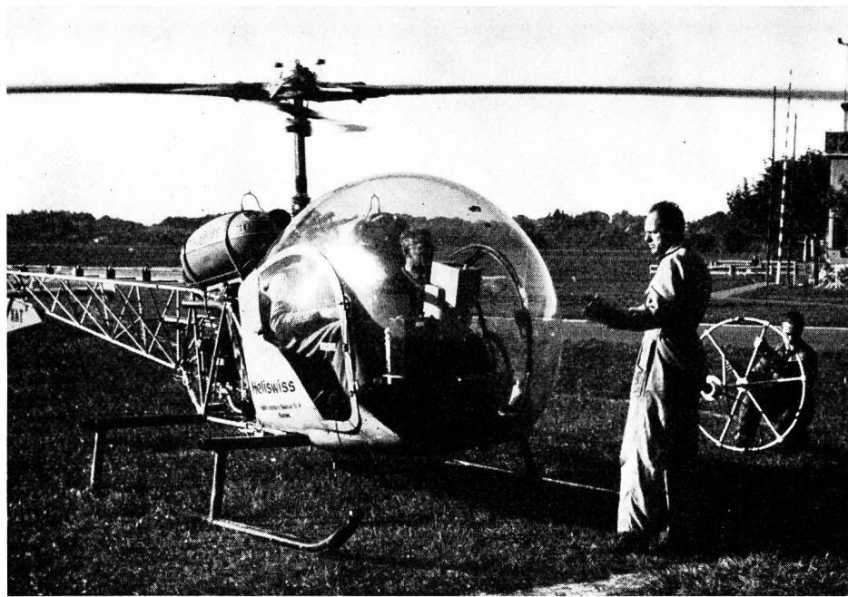
Fig. 7. Vorbereitung der Rundantenne vor dem Start zur Messung der Fernsehantenne La Dôle
