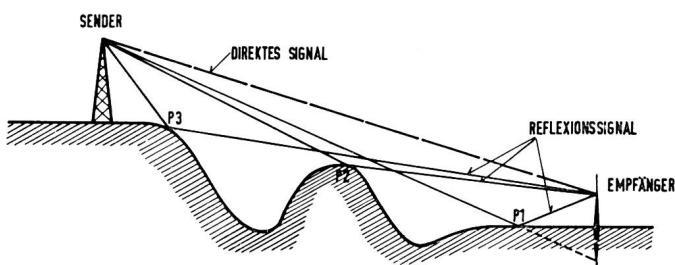
Fig. 3. Mehrwegausbreitung. Am Empfangsort treffen hier zum Beispiel vier Komponenten ein, das direkte Signal und drei Reflexionssignale, die an den Punkten  $P_1$ ,  $P_2$  und  $P_3$  reflektiert werden
