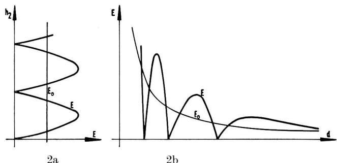
Fig. 2. Praktische Durchführung von Land- beziehungsweise Seemessungen, Aufnahme von  $E = f(h_2)$ , Höhenfunktion nach *Figur 2a* beziehungsweise  $E = f(d)$  nach *Figur 2b*
