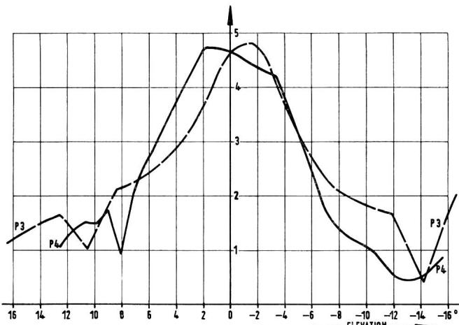
Fig. 10. Vertikaldiagramm des Fernsehsenders Niederhorn. Zwei Messpunkte in der süd-östlichen Hauptkeule, in  $d = 3$  beziehungsweise 5 km Entfernung vom Sender gemessen (Versuchsmessung im Zuge der Planung)
