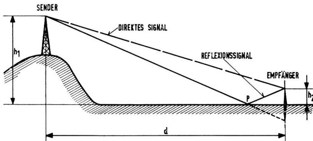
Fig. 1. Zweiwegausbreitung. Am Empfangsort treffen zwei Komponenten ein: das direkte Signal und das Reflexionsignal. Da in der Praxis meist  $h_1 \gg h_2$  ist, befindet sich für diese Fälle die Reflexionsstelle P in der Nähe der Empfangsantenne
