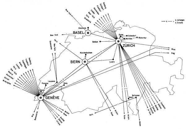
Fig. 2. Schematische Karte der Mietleitungen, Stand: 31.12.1961 (Ohne Pressenetze der SDA und UPI)
