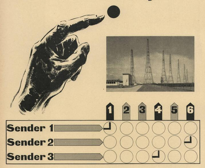
Beliebige Anzahl Sender Beliebige Anzahl Antennen Beliebige Schaltkombinationen Grosse Übersprechdämpfung Gleichmässiger Wellenwiderstand Bedienung von Hand oder durch Fernsteuerung Baukastensystem erlaubt Zusammenbau zu erweiterbaren Gruppen
