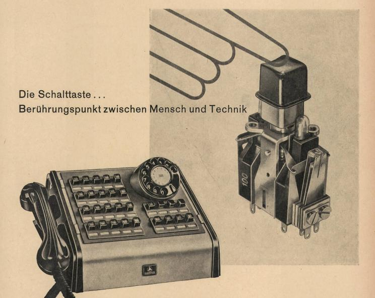
Mit der fortschreitenden Automatisierung des Telephonverkehrs wachsen auch die Anforderungen an die Bedienungsteile der Telephon-Apparate. Verlangt werden besonders Schaltsicherheit, eindeutige Erkennung der Signale, Übersicht und Bequemlichkeit.
