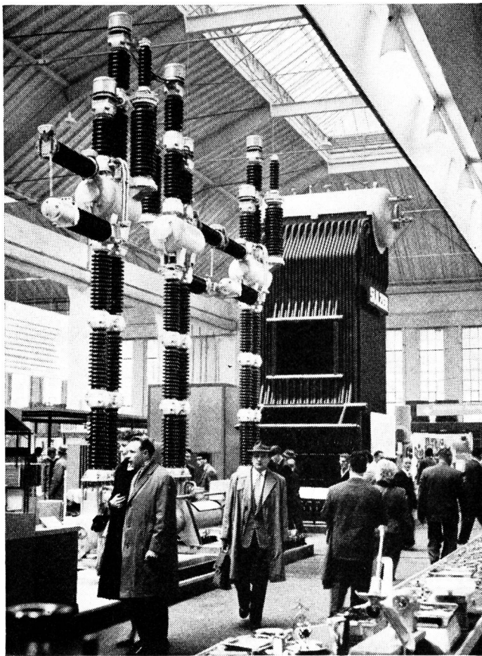
Blick in eine der Hallen der Elektroindustrie und des Grossmaschinenbaues. Im Vordergrund ein 220-kV-Druckluft-Schnellschalter, dahinter ein Strahlungskessel für eine Grossheizung.
