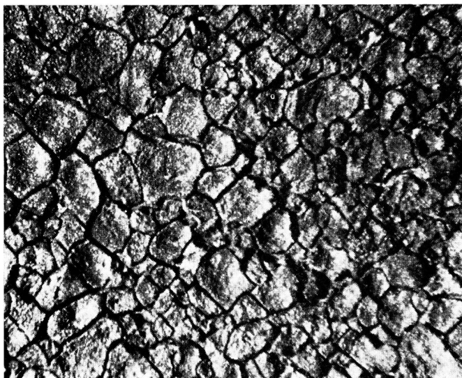
Fig. 5. Deutlich interkristallin angegriffene Oberfläche der vollständig in belüftetes, destilliertes Wasser eingetauchten Bleiprobe Vergrößerung: 15× Surface nettement attaquée par une corrosion inter-cristalline de l'échantillon de plomb complètement immergé dans l'eau distillée aérée Agrandissement: 15×
