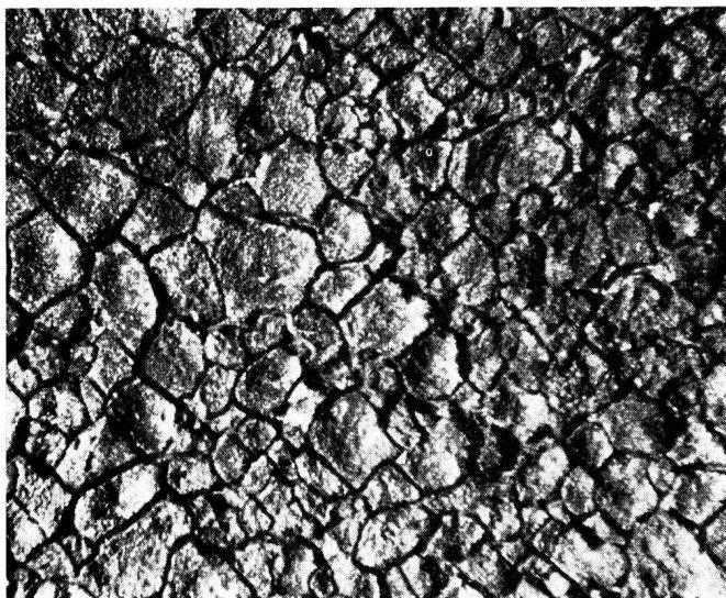
Fig. 5. Deutlich interkristallin angegriffene Oberfläche der vollständig in belüftetes, destilliertes Wasser eingetauchten Bleiprobe
