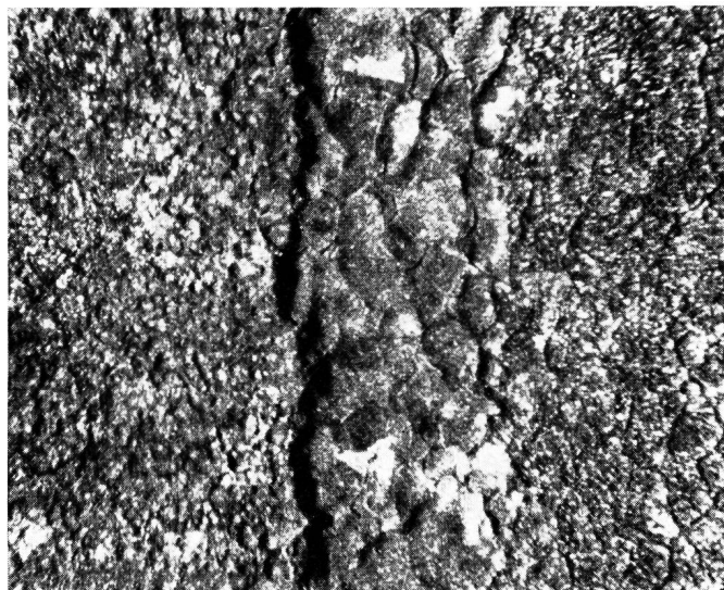
Fig. 4. Beim unbelüfteten Versuch mit einer halbeingetauchten Bleiprobe und destilliertem Wasser mit 0,05% Phenolzusatz als Korrosionsflüssigkeit wurde das Blei in der Grenzzone Flüssigkeit-Luft deutlich stärker angegriffen. Eine interkristalline Korrosion ist trotzdem kaum zu erkennen
