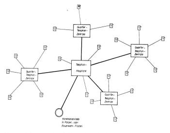
Fig. 1. Schematischer Aufbau der Telephonzentralen einer grössern Stadt
