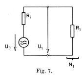
è quella fornita da un generatore avente una resistenza interna di 600 ohm a una resistenza esterna di ugual valore, come indicato nella figura 7.
