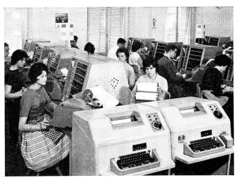
Fig. 2. Fernplatz Zürich. Von hier aus werden alle von den schweizerischen Telexteilnehmern nicht selber herstellbaren Auslandverbindungen halbautomatisch oder manuell vermittelt.
