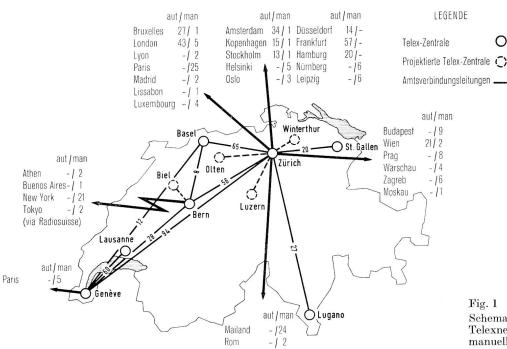
Schematische Karte des schweizerischen Telexnetzes mit den automatischen und manuellen Auslandleitungen
