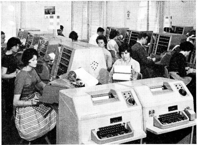
Fig. 2. Fernplatz Zürich. Von hier aus werden alle von den schweizerischen Telexteilnehmern nicht selber herstellbaren Auslandverbindungen halbbautomatisch oder manuell vermittelt
