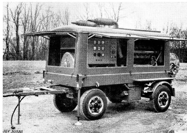
Fig. 20. Fahrbare Notstromanlage auf Zweiachsanhänger. Leistung 125 kVA, 220/380 V, 50 Hz, mit Antrieb durch Benzinmotor
