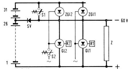
Fig. 6. Prinzipschaltung einer 60-V-Energieversorgungsanlage mit zwei Gleichrichtern *Gl1* und *Gl2* und den Reglern *R1* und *R2* sowie den dazugehörigen Zusatzgleichrichtern *ZGl1* und *ZGl2*. Das Sperrventil *SV* wird im Gegensatz zu der Anlage Figur 5 nie kurzgeschlossen. Weitere Bezeichnungen siehe Figur 3
