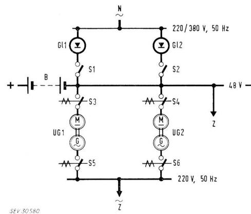
**Fig. 12.** Prinzip einer Energieversorgungsanlage 220 V, 50 Hz, für Koaxialkabelverstärker. Solche Anlagen werden für Leistungen bis 10 kVA eingesetzt
