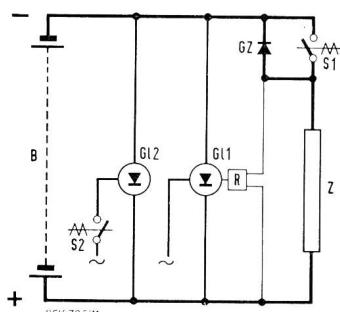
Fig. 3. Prinzip einer 48-V-Energieversorgungsanlage mit Gegenzellenlement *GZ* für kleinere automatische Telefondzentralen bis zu einem maximalen Belastungsstrom von 60 A
