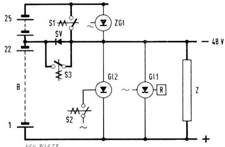
Fig. 5. Prinzipschaltung einer 48-V-Energieversorgungsanlage mit Unterteilung der Batterie und Zusatzgleichrichter *ZGl*. Das Sperrventil *SV* ist im Normalbetrieb durch *S3* kurzgeschlossen. Der Gleichrichter *Gl2* wird durch *S2* nach Bedarf zugeschaltet. Weitere Bezeichnungen siehe Figur 3
