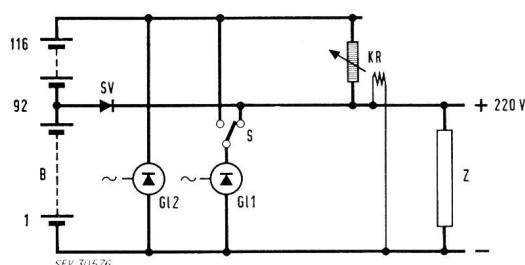
Fig. 8. Prinzipschaltung einer Energieversorgungsanlage für Anodenspannung 220 V mit Kohledruckregler  $KR$ , Batteriezapfung bei 92 Zellen und Sperrventil  $SV$
