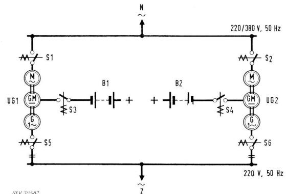
Fig. 14. Prinzip einer Energieversorgungsanlage 220 V, 50 Hz, für Koaxialkabelverstärker bei Leistungen über 10 kVA. Bezeichnungen siehe im Text
