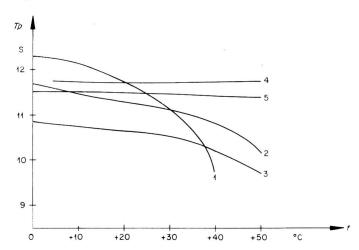
Fig. 23. Temperaturabhängigkeit der Periode Tp des Taktgebers nach Fig. 22
