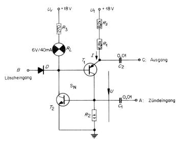
Fig. 28. Ringzähler-Einheitsstufe mit Vierpolschalter S<sub>N</sub>
