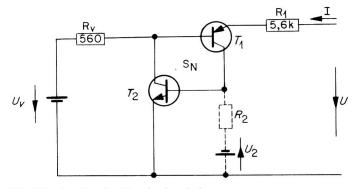
Fig. 25. Amplituden-Vergleichsschaltung
