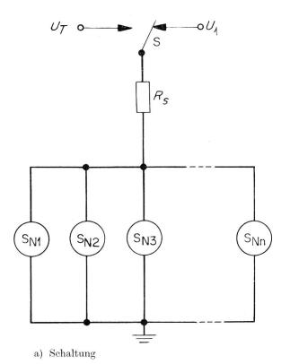
Fig. 34. Sperrschaltung mit Dreipolschaltern
