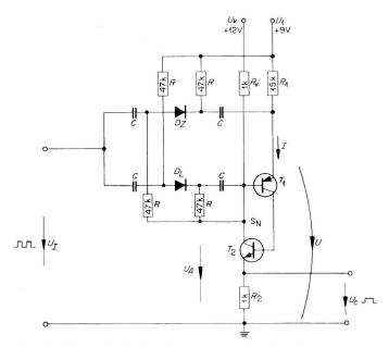
Fig. 30. Binäre Einheitsstufe mit Dreipolschalter S<sub>N</sub>
