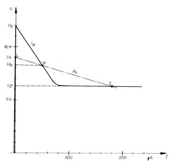
Fig. 31. Schalteharakteristik  $U={\rm f}\left(I\right)$  des Dreipolschalters von Fig. 30,  $\alpha_{En}\approx77$
