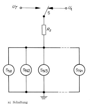
Fig. 33. Sperrschaltung mit Zweipolschaltern
