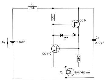
Fig. 24. Blinker mit Zweipolschalter
