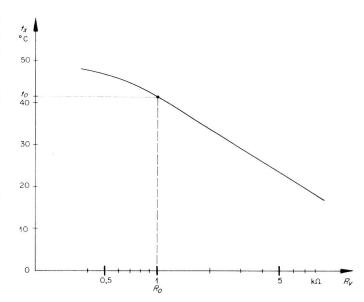
Fig. 27. Einschalttemperatur  $t_x$  des Temperaturschalters von Fig. 26
