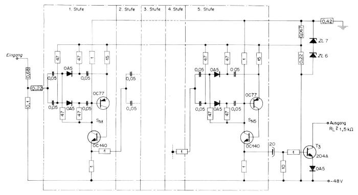
Fig. 32. Gesamtschema des Untersetzers 32:1 (R in  $k\Omega$ , C in  $\mu$ F)
