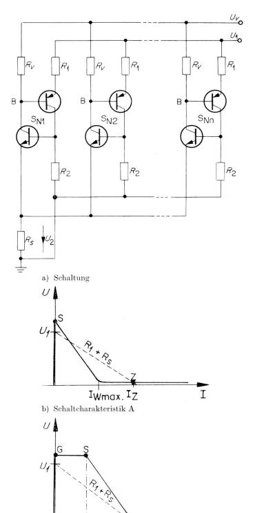
c) Schaltcharakteristik B Fig. 35. Sperrschaltung mit Vierpolschaltern
