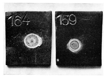
Fig. 7. Veränderung auf der Bleioberfläche nach zehntägiger Einwirkung einer Glaskugel. Elektrolyt war beim Bild links  $n/100~{\rm NaNO_3}$  in Leitungswasser und beim Bild rechts Leitungswasser. Vergrösserung 1:2
