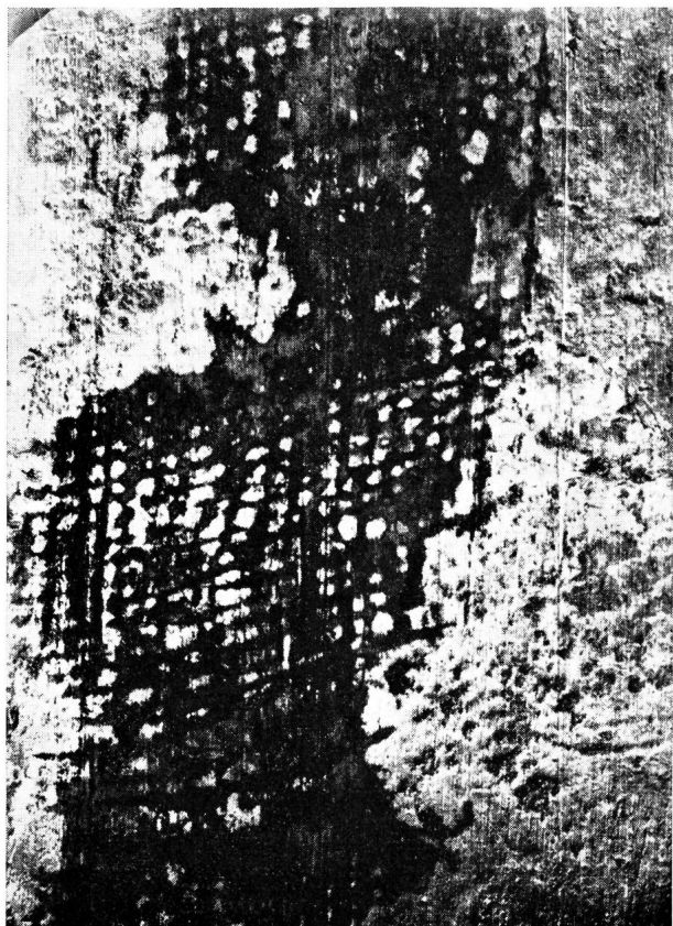
Fig. 3. Schwarzgefärbte Fleckenbildung bei einer mit Baumwollband umwickelten Bleiplatte, die das Abbild der Umwicklung zeigt. Vergrösserung 1:4
