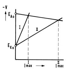
Fig. 5. Infolge der Verringerung der kathodischen Polarisation erhöhter maximaler Strom
