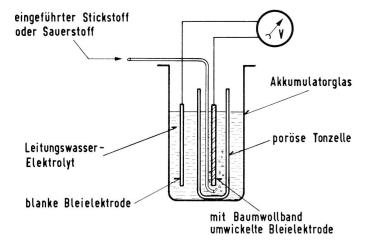
Fig. 1. Differential belüftetes Elektrodenpaar mit Gaseinführung
