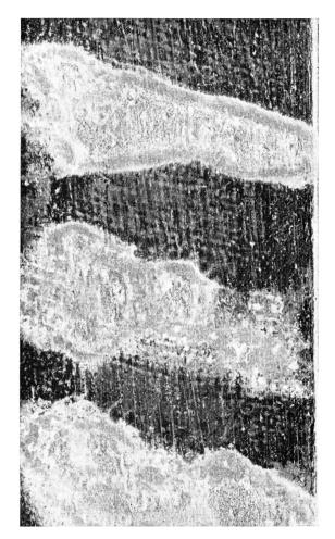
Fig. 10. Mit Baumwollband umwickelte, in destilliertem Wasser korrodierte Bleiplatte. Vergrösserung 1:3,7
