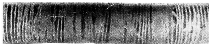
Fig. 4. Abbild eines mit Hanffäden umwickelten Bleirohres nach zweimonatigem Stehenlassen in Leitungswasser. Vergrösserung 1:0,45
