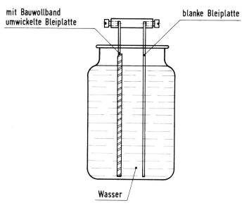
Fig. 2a. Differential belüftetes Elektrodenpaar
