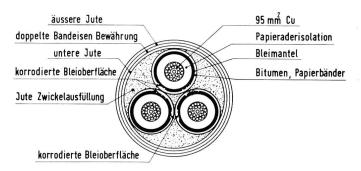
Fig. 11. Querschnitt eines korrodierten 30-kV-Dreimantelkabels
