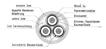
Fig. 15. Querschnitt eines andern Typs eines 30-kV-Dreimantelkabels
