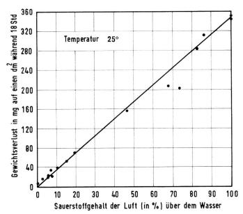
Fig. 9. Einfluss von Sauerstoff auf die in destilliertes Wasser eingetauchte Bleiplatte
