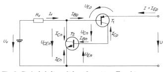
Fig. 2. Dreipolschalter mit komplementären Transistoren
