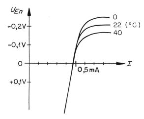
Fig. 11. Vierpolschalter Nr. 1  $\begin{array}{c} {\rm T_1\colon OC\ 77,\ T_2\colon OC\ 140} \\ {U_v=12\ V,\ R_v=1\ k\Omega} \\ {U_2=1,55\ V,\ R_2=3,2\ k\Omega} \end{array}$
