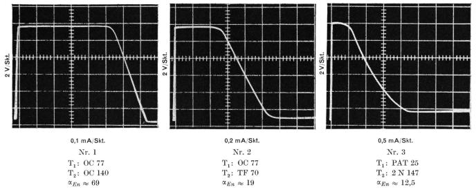
Fig. 9. Schaltcharakteristiken U=f (I) von Vierpolschaltern mit  $U_2=$ 1,55 V,  $U_v=$ 12 V,  $R_v=$ 1 k $\Omega$ ,  $R_2=$ 3,2 k $\Omega$ , t=22° C
