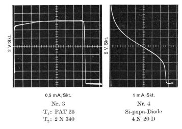
Fig. 17. Schaltcharakteristiken U=f(I) von Zweipolschaltern  $R_{Bj}=0,\ R_{Ep}=R_{En}=320\ \Omega,\ t=22^{\circ}\ C,\ \mathrm{Dr}\colon 2\times\mathrm{Z7}$
