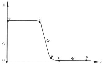
Fig. 7. Schaltcharakteristik des Vierpolschalters
