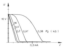
Fig. 14. Einfluss des Sperrwiderstandes  $R_2$  auf den Vierpolschalter Nr. 1, Uv=12 V, Rv=1 k $\Omega$ ,  $U_2=0$ , t=22°C
