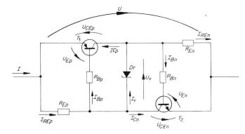
Fig. 15. Zweipolschalter mit komplementären Transistoren
