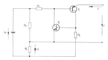
Fig. 8. Vierpolschalter mit Spannungsteiler Ra, Rb, zur Erzeugung der Sperrspannung  $U_2$
