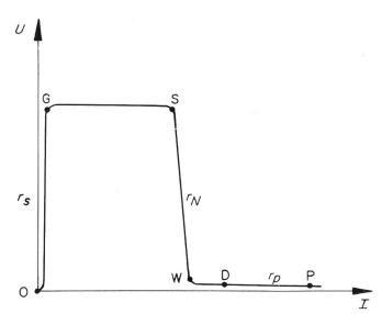
Fig. 16. Schaltcharakteristik des Zweipolschalters
