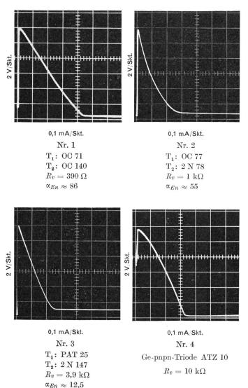
Fig. 4: Schaltcharakteristiken  $U={\rm f}\left(I\right)$  von Dreipolschaltern  $U_v=12\,{\rm V},\ t=22^{\circ}\,{\rm C}$
