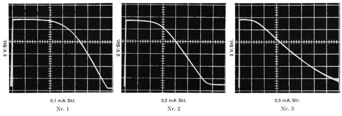
Fig. 10. Schaltcharakteristiken  $U=\mathrm{f}\left(I\right)$  von Vierpolschaltern mit  $U_{2}=\mathrm{o},\ R_{2}=0{,}38\ \mathrm{k}\Omega,$  die übrigen Daten wie in Fig. 9
