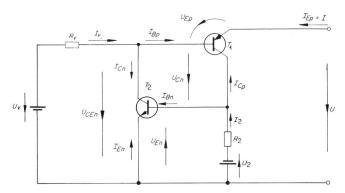
Fig. 6. Vierpolschalter mit komplementären Transistoren
