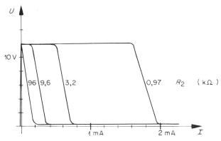
Fig. 13. Einfluss des Sperrwiderstandes  $R_2$  auf den Vierpolschalter Nr. 1,  $U_v=12$  V,  $R_v=1$  k $\Omega$ ,  $U_2=1,55$  V,  $t=22^{\circ}$  C
