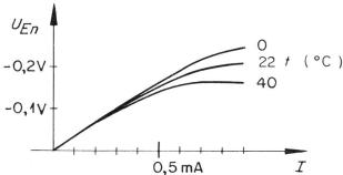
$\begin{array}{cccc} \text{Fig. 12.} & \text{Vierpolschalter} & \text{Nr. 1} \\ & T_1 \colon \text{OC 77,} & T_2 \colon \text{OC 140} \\ & U_v = 12 \; \text{V,} & R_v = 1 \; \text{k}\Omega \\ & U_2 = 0, & R_2 = 0.38 \; \text{k}\Omega \end{array}$
