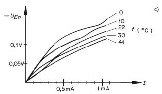
Fig. 19. Zweipolschalter Nr. 2  $R_{Bj} = 0, \ R_{Ep} = R_{En} = 320 \,\Omega, \ D_r : 2 \times Z7$
