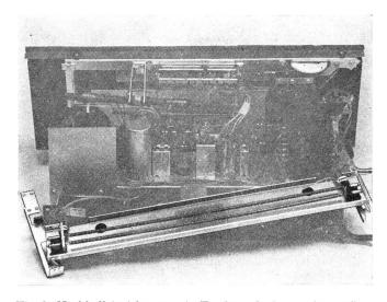
Fig. 2. Nachhalleinrichtung mit Torsionsschwingern in geöffnetem Zustand bei einem Philips-Modell
