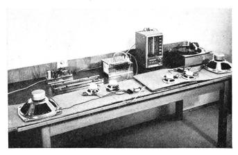
Fig. 1. Rundfunk-Bausteine von Grundig. Hinten, von links nach rechts: Nachhalleinrichtung, Stereoverstärker, Rundfunk-Empfangsteil, Plattenwechsler; vorne: Lautsprecherkombination für Stereowiedergabe
