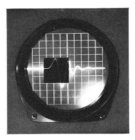
Fig. 8. Magnetische Folie auf dem Bildschirm eines Oszillographen. Infolge der geringen Dicke (von nur <sup>1</sup>/<sub>10000</sub> mm oder rund 50 Atomschichten) ist sie für unser Auge bereits durchsichtig
