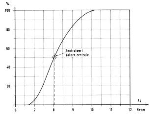
Fig. 3. Verteilung von Nebensprechdämpfungen Ripartizione delle attenuazioni di diafonia
