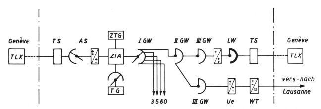
Fig. 1. Diagramme d'une communication partant de Genève – Diagramm einer von Genf abgehenden Verbindung
