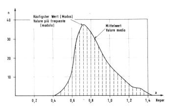
Fig. 2. Dämpfungswerte eines Leitungsbündels mit asymmetrischer Verteilung
