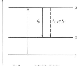
Fig. 2 \_\_\_\_\_ induzierte Emission \_\_\_\_ spontane Emission
