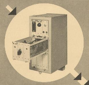
Gehäuse mit Baukasten-Elementen für die Übertragung von TONFREQUENZ-SIGNALEN zum :
