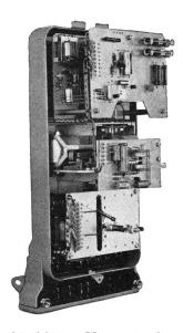
Fig. 10. Volltransistorisierter Messwertumformer Gleichstrom-Impulsfrequenz
