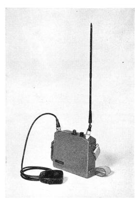
Fig. 4. SE-18-Funktelephon. Oben Anschluss für Bedienungsgerät, Kanalwähler, Squelch-Schalter, Antennenanschluss. Links vorne Monophon mit Sprechtaste, Ruftaste und Ein-Aus-Schalter
