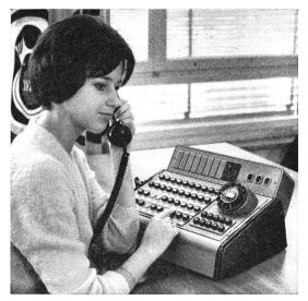
Fig. 2. Albis-Vermittlungsstation mit Leuchttasten und eingebautem Nummernanzeiger
