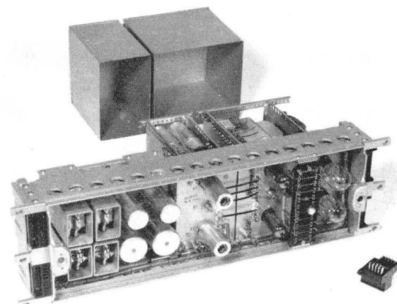
Fig. 11. 2-Watt-Verstärker. Ansicht von vorn
