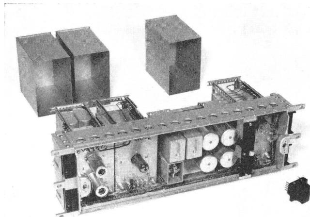
Fig. 10. 500-mW-Verstärker. Ansicht von vorn
