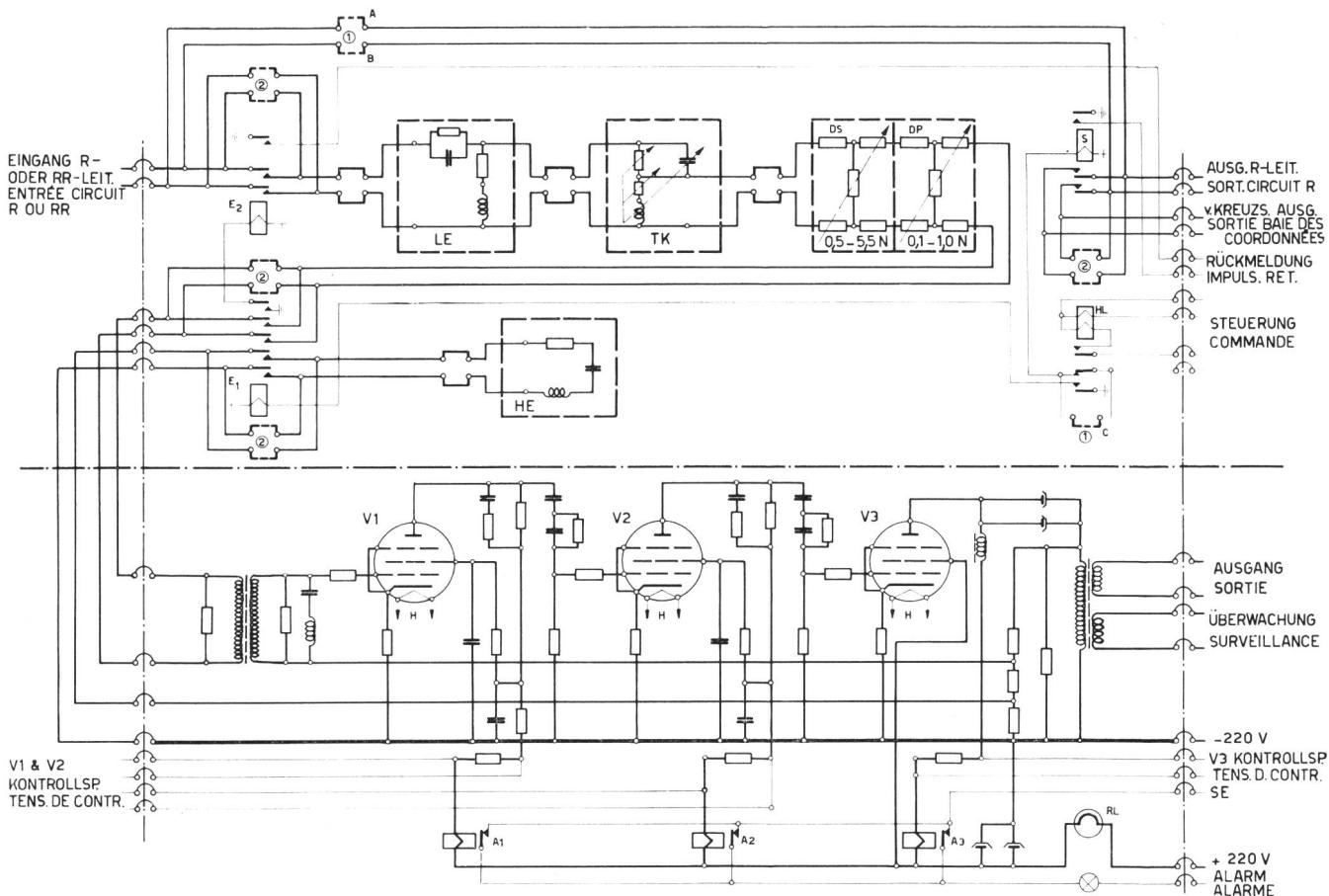
Fig. 9. Schema Linienpaneel und 500-mW-Verstärker – Schéma du panneau de ligne et de l'amplificateur 500 mW
