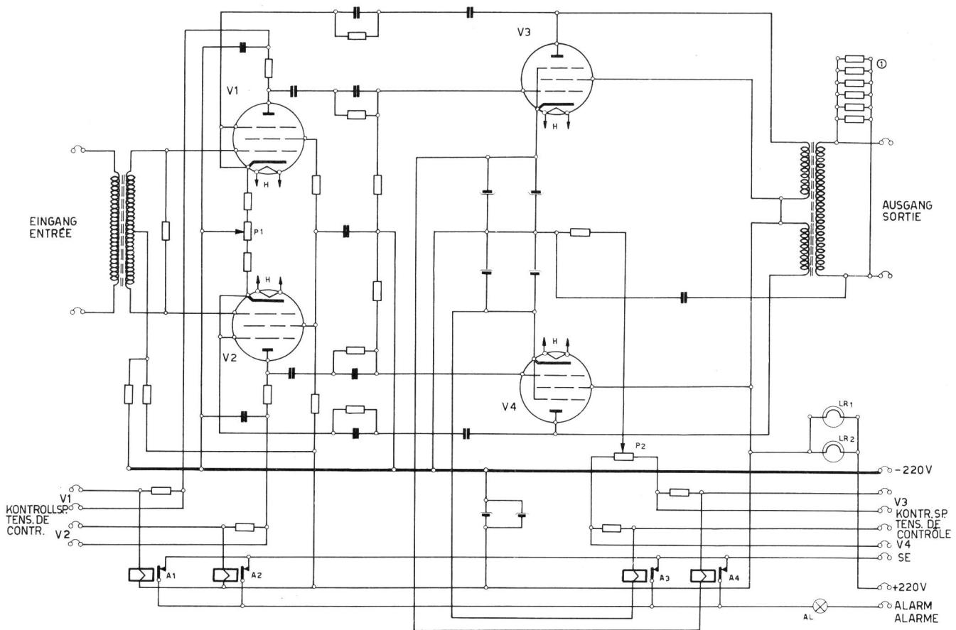
Fig. 12. Schema 2-Watt-Verstärker – Schéma de l'amplificateur de 2 watts
