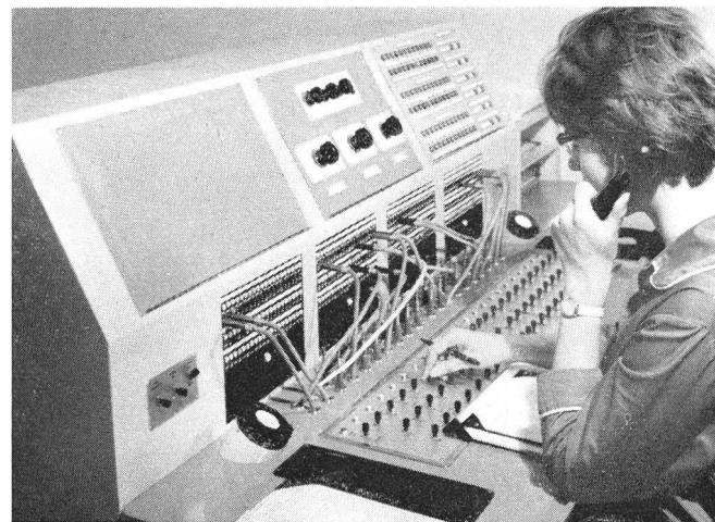
Fig. 6. Dienstpult mit Klinkenfeld, HF- und NF-TR-Überwachung und dem Alarmlampenfeld
