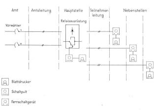
Fig. 1. Grundsätzlicher Aufbau der Nebenstellenanlagen
