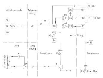
Fig. 3. Blockschema der Fernschreibzentrale 4/10
