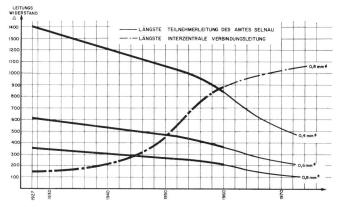
Fig. 12. Entwicklung der Leistungswiderstände
