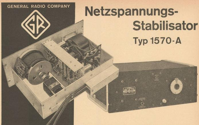
Dieser servo-mechanische • hohe Belastbarkeit Spannungs-Schnellregler besteht im wesentlichen aus einem motorangetriebenen, kugelgelagerten Variac-Regeltransformator kleinerer Leistung, einem Stufentransformator mehrfacher Leistung, einer Steuereinheit und dem Servomotor, der durch automatische Einstellung des Variacs die Ausgangsspannung konstant hält.
