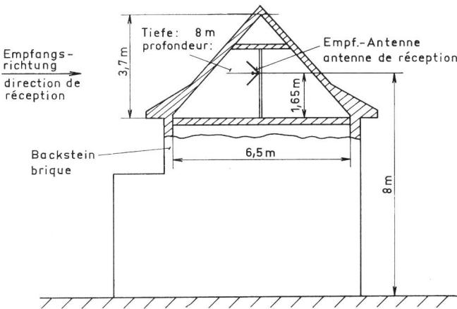
Fig. 1. Dachstuhl des Messobjektes.
