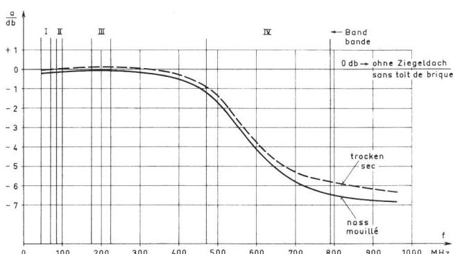
Fig. 2. Dämpfungseinfluss eines Ziegeldaches bei Estrahntennen
