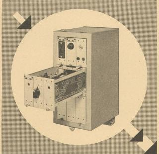
Gehäuse mit Baukasten-Elementen für die Übertragung von TONFREQUENZ-SIGNALEN zum: FERN-MESSEN
