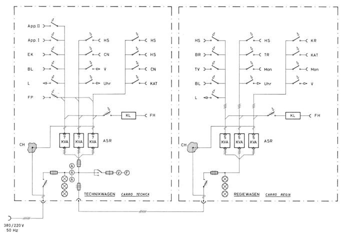
Fig. 8. Schema der Netzstromversorgung
