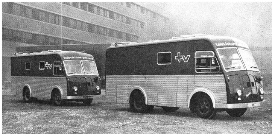
Fig. 1. Der neue Fernseh-Übertragungszug für die Südschweiz. Die Anlage ist auf zwei Fahrzeuge aufgeteilt, den Technikwagen (links) und den Regiewagen (rechts)
