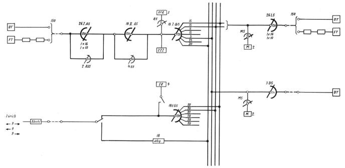
Fig. 3. Schema di principio centrale telex Lugano
