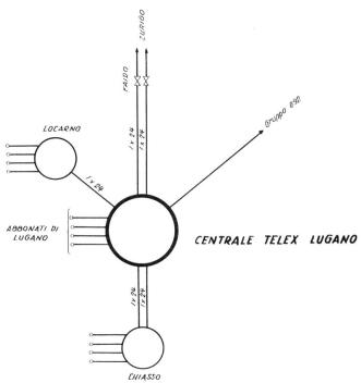
Fig. 2. Rete telex 1959 con centrale propria
