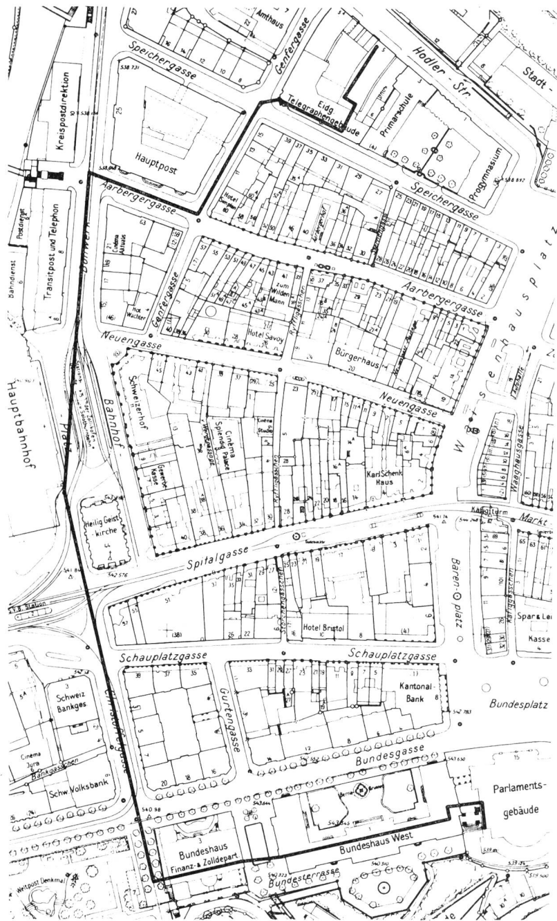
Fig. 7. Trajekt des Video-Ortskabels
