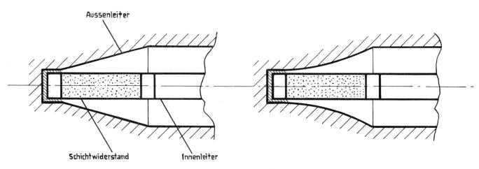
Fig. 2. Abschlüsse mit Innenleiterschichtwiderständen
