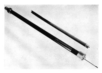
Fig. 7. Oben: Ein ausgebautes Widerstandselement Unten: Ansicht eines Abschlusswiderstandes
