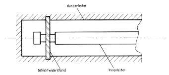
Fig. 1. Abschluss mit Schichtwiderstand in Scheibenform
